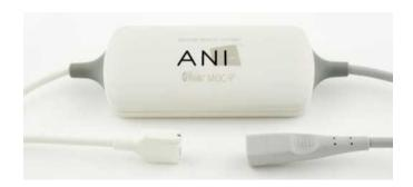
ANI MOC-9 berechnet den ANI mit den von den ANI-Sensoren erfassten Signalen. Diese Messungen werden wiederum am Root-Monitor angezeigt.
