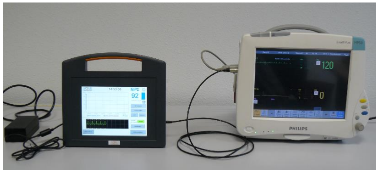
Kuva 2: Esimerkki kytkennästä Philips MP50 -monitoriin
