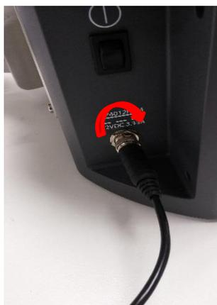
El conector eléctrico se conecta al monitor de forma habitual. Para prevenir una desconexión accidental, se puede bloquear el conector atornillando el cabezal moviendolo de derecho a izquierda según imagen.
