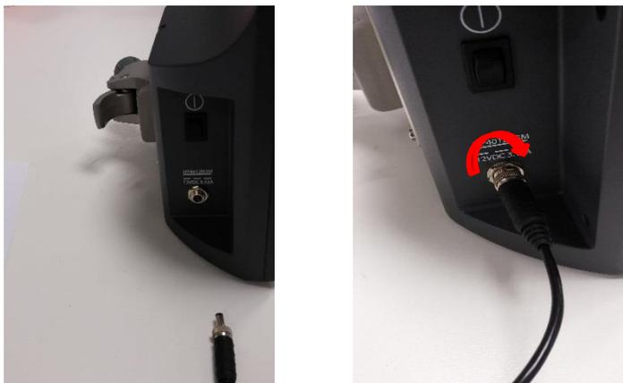
Il raccordo di collegamento alla rete elettrica viene solitamente inserito alla base. Per evitare disconnessioni accidentali, è possibile bloccare l'innesto avvitando alla rondella sulla base (da sinistra a destra, vedi immagine sopra).
